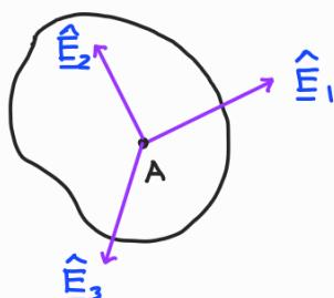
$$\left[ \underline{\underline{I}}^A \right] = \begin{bmatrix} I_{11}^{A'} & I_{12}^{A'} & I_{13}^{A'} \\ I_{21}^{A'} & I_{22}^{A'} & I_{23}^{A'} \\ I_{31}^{A'} & I_{32}^{A'} & I_{33}^{A'} \end{bmatrix}$$
